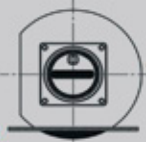
выдвижной модуль MCC с рукояткой типа KE200
