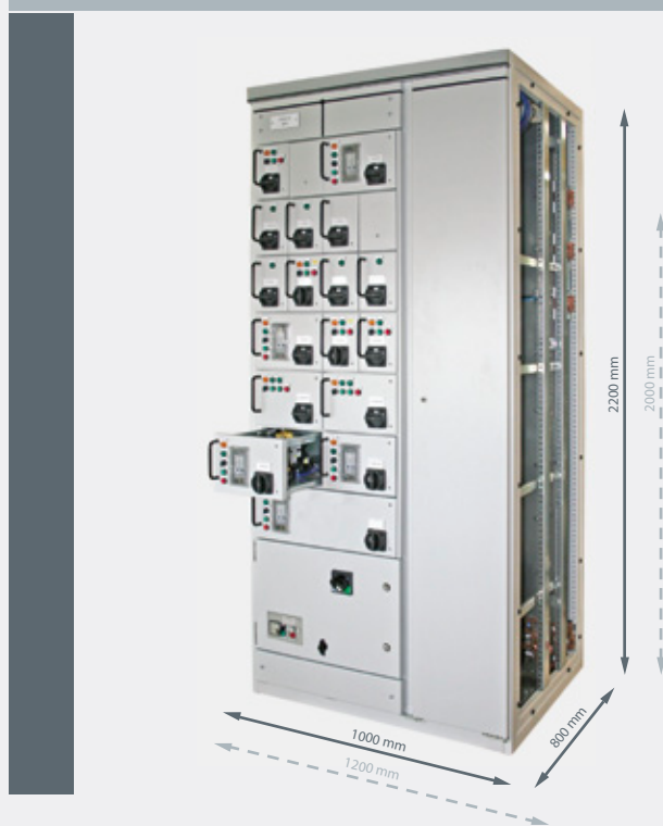
Шкаф F51 Шкаф МСС с 6-тью секциями ячеек (10 x 1/4 и 6 x 1/2 модулей), 1 x E1H, 1 x KE400
